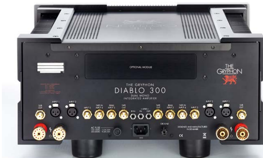
Den store luckan på baksidan döljer öppningen till DAC-sektionen som går att byta ut.
