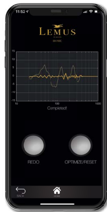
I appen kan man göra rumsoptimering för att få ännu bättre ljud. Den tunna kurvan är testarens inte helt optimala TV-rum. Den tjockare grafen är efter optimering. Foto: skärmdump
