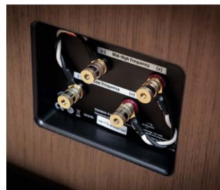
Dubbla terminaler för de som vill driva högtalarna med två förstärkare eller bara använda bi-wiring.
